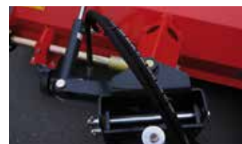
hydraulische Seitenverstellung (optional)
