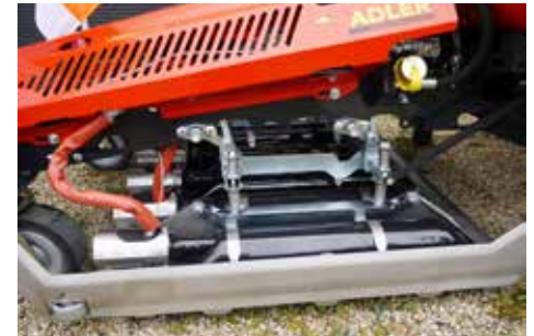
Federnd gelagerte und per Funkfernbedienung höhenverstellbare Infrabox
