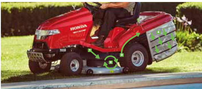
▲ Mähdeck mit synchron laufenden Messern
