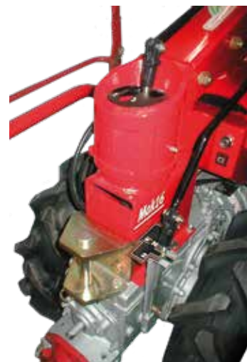
Schaltkulisser, Anhängerkupplung + Zapfwelleneinstellung MAK 17
