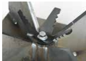
Piranha-Messer zur Volumenreduzierung
