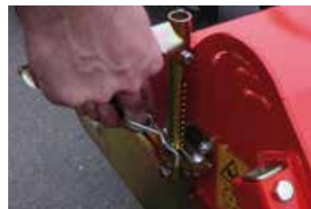
Höhenverstellung der Bürste
