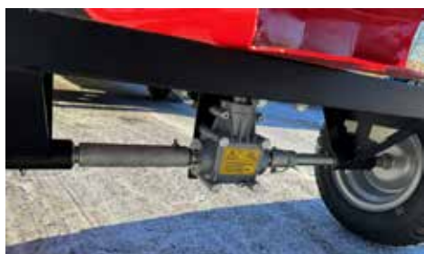
Verstärktes Metallgetriebe mit zuschaltbarem Freilauf für Überführungsfahrten
