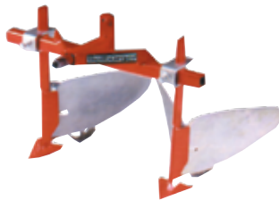
Häufelkörper 2-reihig Spindelkopfstück erforderlich
