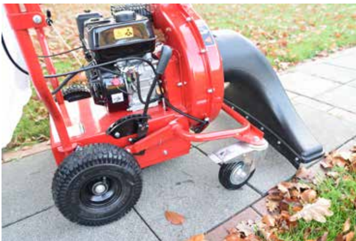
Höhenverstellung und lenkbare Vorderräder mit Bremse
