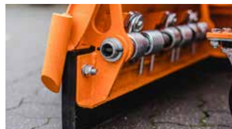
Federklappenelemente mit Gummileiste
