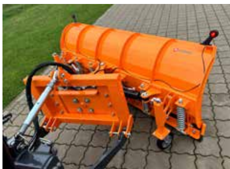
Niveaue Ausgleich, seitlicher Anfahrerschutz
