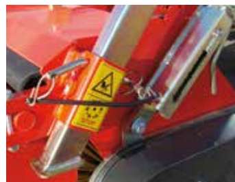
Abstellstütze und stufenlos höhenverstellbare Kehrwalze
