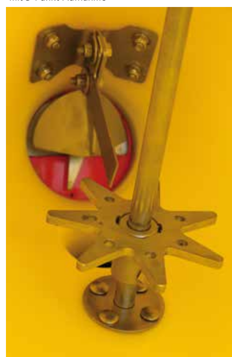
zusätzliches Rührwerk gegen Brückenbildung
