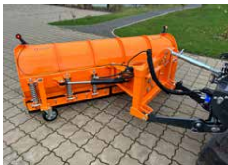
Federklappen als Überfahrerschutz, höhenverstellbare Stützräder
