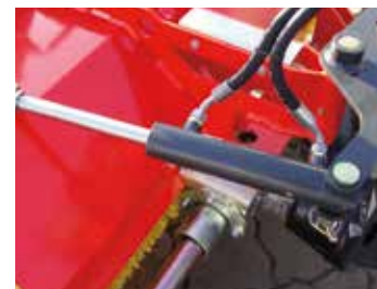
hydraulische Seitenverstellung (optional)
