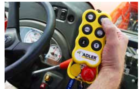
Funkfernbedienung mit Saugnapfhalterung und Notaus
