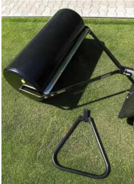
Kombi-Rasenwalze „Profi“ Breite 103 cm, Ø 46 cm, Leergewicht 43 kg, Gewicht der mit Wasser gefüllten Walze 200 kg, 2 Füll- und Ablassöffnungen, inkl. Wischleiste aus Edelstahl. Dank des Kombigriffs ist die Walze sowohl als Handwalze und als gezogene Walze einsetzbar.
