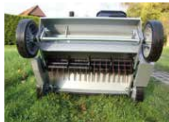
Am Fliehkraftsystem aufgehängte, gehärtete 3 mm Vertikutiermesser
