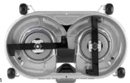
▲ Mähdeck mit synchron laufenden Messern
