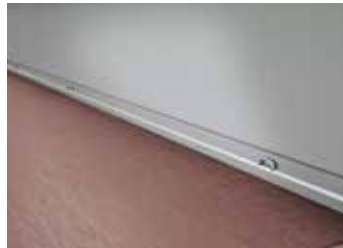
Zurringe in den Seitenwänden integriert
