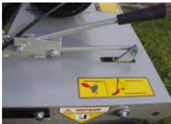
Stabiler Absenkmehanismus mit Feinjustierung
