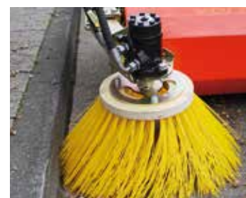
hydraulisch angetriebener Seitenbesen (optional)
