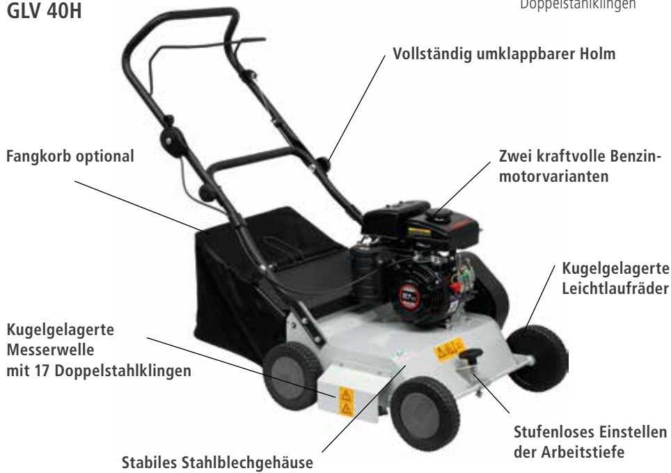
Kugelgelagerte Vertikutierwelle mit gehärteten Doppelstahlklingen
