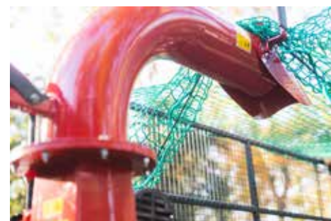
Schwenkbarer Auswurfkanal und verstellbare Auswurfklappe
