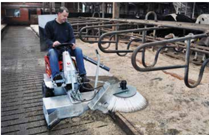
CM 2 Pro mit Spaltenschieber ASS 900 und Seitenbesen
