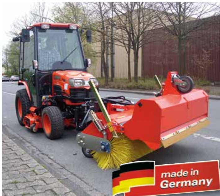
Abstellstütze und stufenlos höhenverstellbare Kehrwalze
